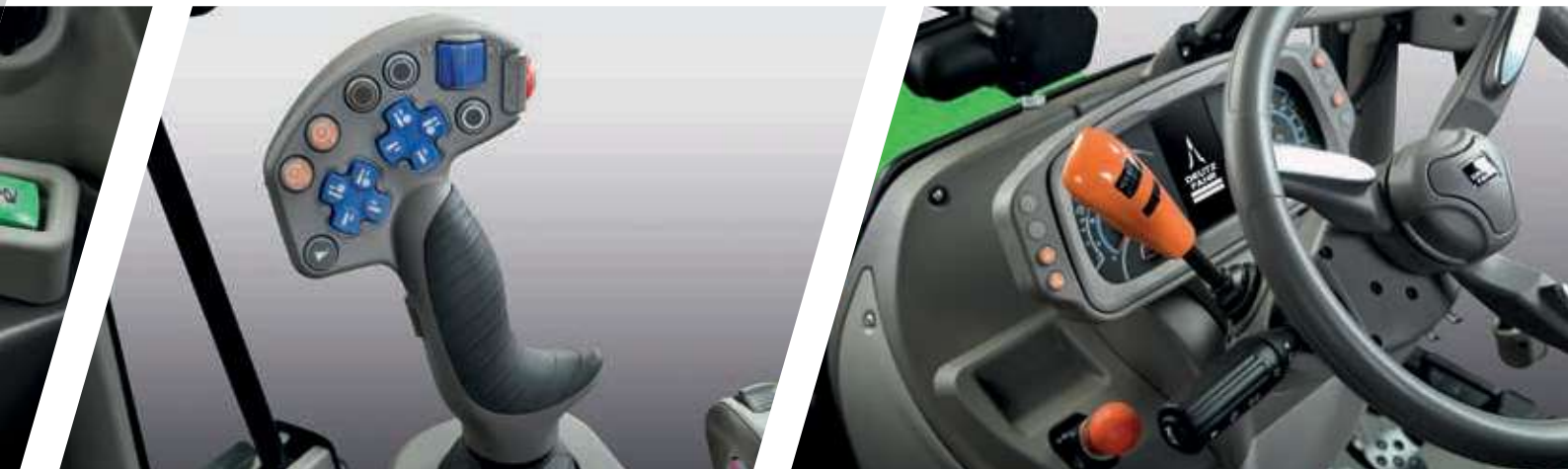
> MaxCom-Joystick für eine einfache Bedienung der Fahrfunktionen.
