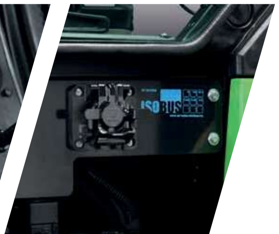
> ISOBUS: Sie können jeden Anbaugerätetyp anschließen und von verschiedenen ISOBUS-Funktionen profitieren.
