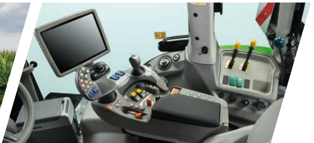
> Ergonomischer MaxCom-Joystick mit Krafthebertasten, Motor- und Getriebesteuerung, Vorgewendemanagement und zwei proportionalen Hydraulikventilen.
