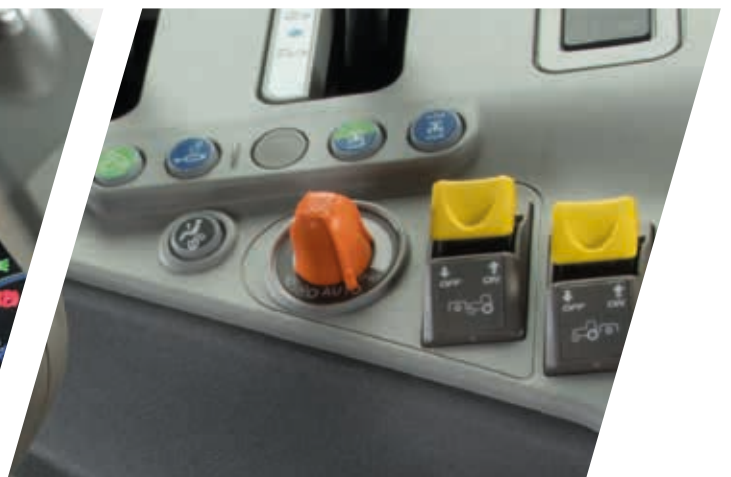
> Einfach und intuitiv – mit dem ECO/Power-Regler kann der Fahrer das APS (Automatic Powershift)-Schaltverhalten ändern.
