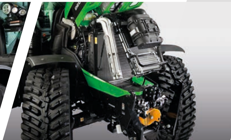
> Aluminium-Kühlsystem Performance pro mit Einhand-Auslösehebel für die Modelle 6210-6230.
