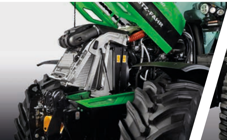
> Aluminium-Kühlsystem Performance + mit Einhand-Auslösehebel für die Modelle 6160-6190.
