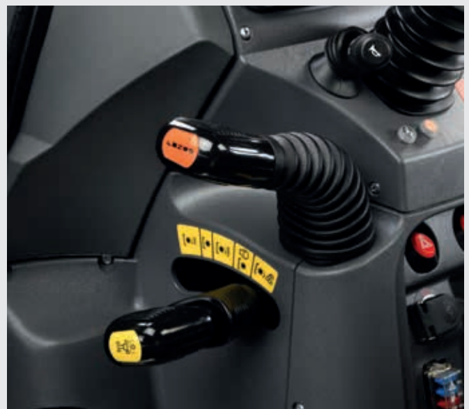
↑ Mechanisches Getriebe mit synchronisierter Wendeschtaltung.
