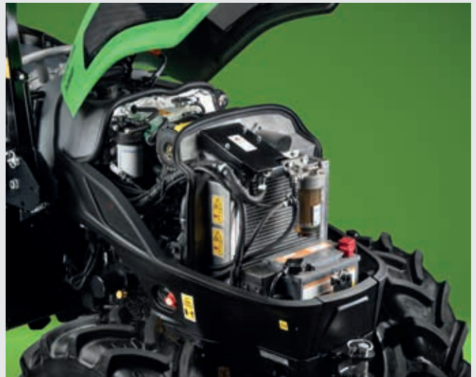
↑ Stufe-V-konforme Motoren mit Common-Rail-Einspritzung und einer Leistung von bis zu 59 PS.
