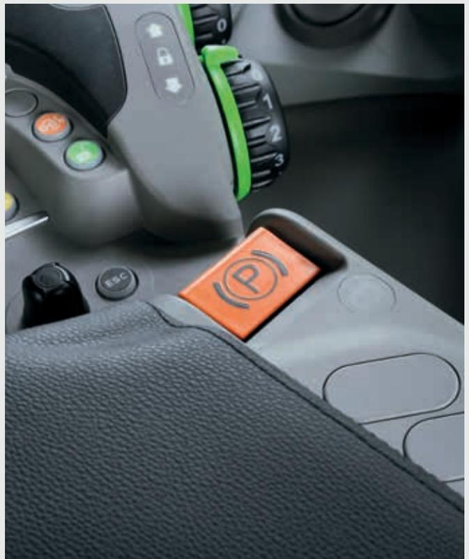
Bei den TTV-Modellen ersetzt die EPB den mechanischen Handbremshebel; sie wird über eine elektrische Taste an der Armlehnenkonsole bedient.
