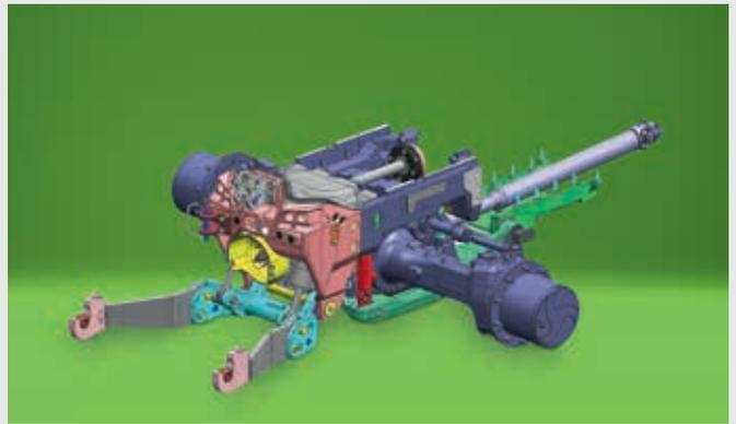
Elektronisch gesteuerte Federung mit Stabilitäts- und Positionsregelung. Die Federung kann sowohl auf dem Feld als auch auf der Straße eingesetzt werden. Bei Bedarf kann sie vollständig deaktiviert werden.
