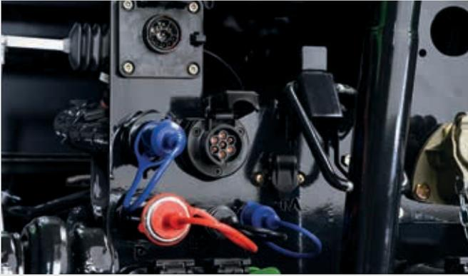
↑ Die DEUTZ-FAHR ISOBUS-Schnittstellen an Front und Heck machen den Traktor mit Anbaugeräten aller namhaften Hersteller kompatibel.
