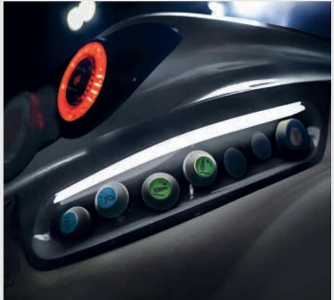
↑ LED-Beleuchtung der Bedienelemente am Kotflügel.
