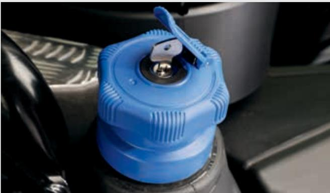
↑ Abschießbare Tankdeckel für Kraftstoff- und AdBlue-Tanks.
