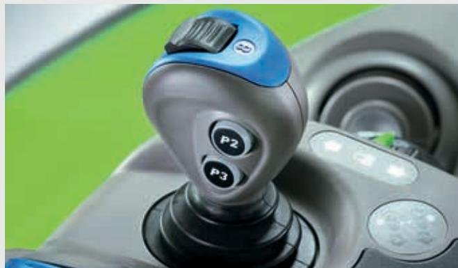
Die Hydraulikventile sind mit einer Proportionalsteuerung ausgestattet und können vollständig für Zeit und Durchflussmenge programmiert werden. Der elektronische Joystick kann für die Bedienung des Frontladers verwendet werden; während andere Steuerventile über das Daumenrad bedient werden können.
