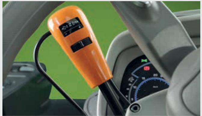
↑ PowerShuttle mit SenseClutch und fünfstufig einstellbarem Ansprechverhalten.
