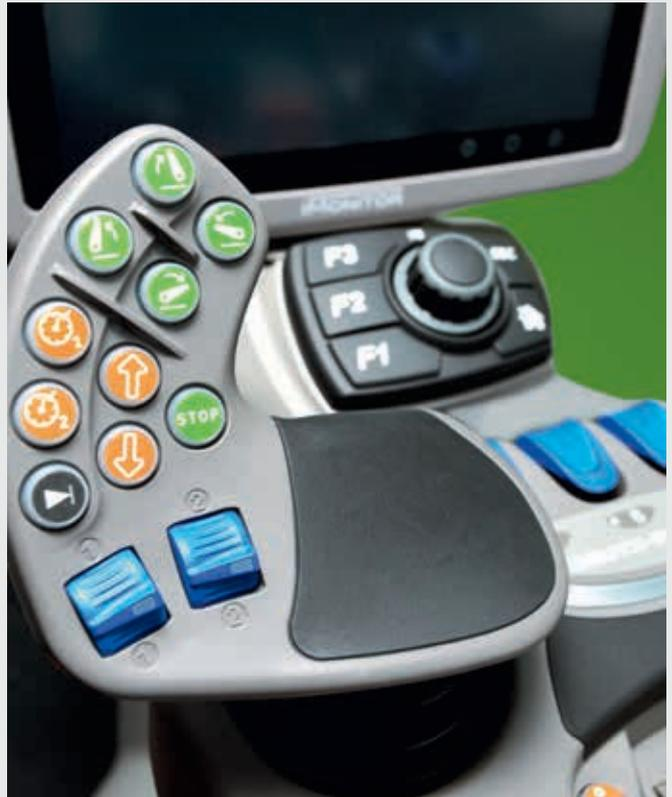
↑ Mit zwei Tempomat-Tasten auf dem MaxCom-Multifunktionsjoystick kann der Fahrer vier verschiedene Geschwindigkeitseinstellungen für Arbeiten auf dem Feld oder auf der Straße abrufen und eine konstante Geschwindigkeit für optimale Ergebnisse aufrechterhalten.
