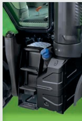
↑ Die 6-Zylinder-Modelle verfügen über beidseitige Tankeinfüllstutzen, was die Handhabung erleichtert.
