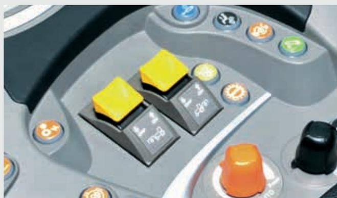
Die Zapfwellenzuschaltung ist bei allen Kabinenvarianten einfach und zuverlässig über einen Druckknopf zu bedienen.
