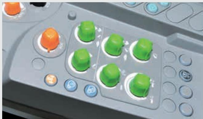
Die Steuerung des Front- und des Heckkrafthebers kann mit den Potentiometern in der Armlehne fein eingestellt werden.
