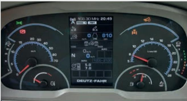
↑ Moderne Instrumententafel mit InfoCentre<sup>PRO</sup>: Hochauflösendes 5-Zoll-Display. Das verfügbare iLock-System sorgt für Sicherheit – Ver- und Entriegeln des Traktors mit einer PIN.
