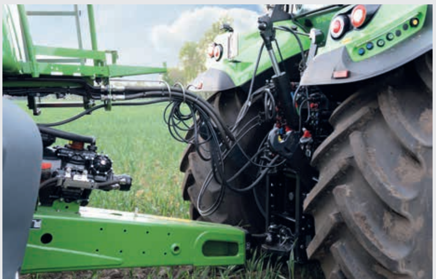
↑ Heckhubarme in Transportstellung für entspannte Kurvenfahrten.
