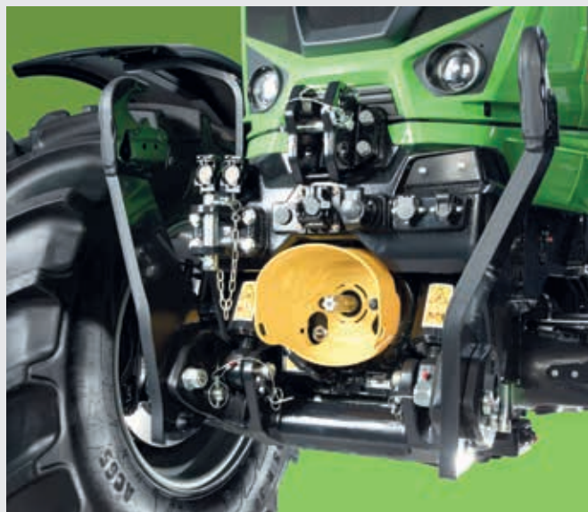
Frontkraftheber mit 5450 kg Hubkraft und DualSpeed-Frontzapfwelle.
