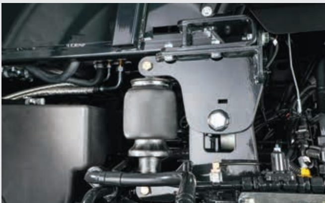
↑ Luftgedertete Kabine für maximalen Fahrkomfort.
