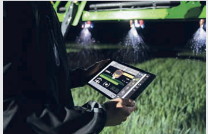
↑ XTEND-Funktion mit Tablet, Steuerung von Anbaugeräten über ISOBUS UT, während Sie sich außerhalb der Kabine befinden.
