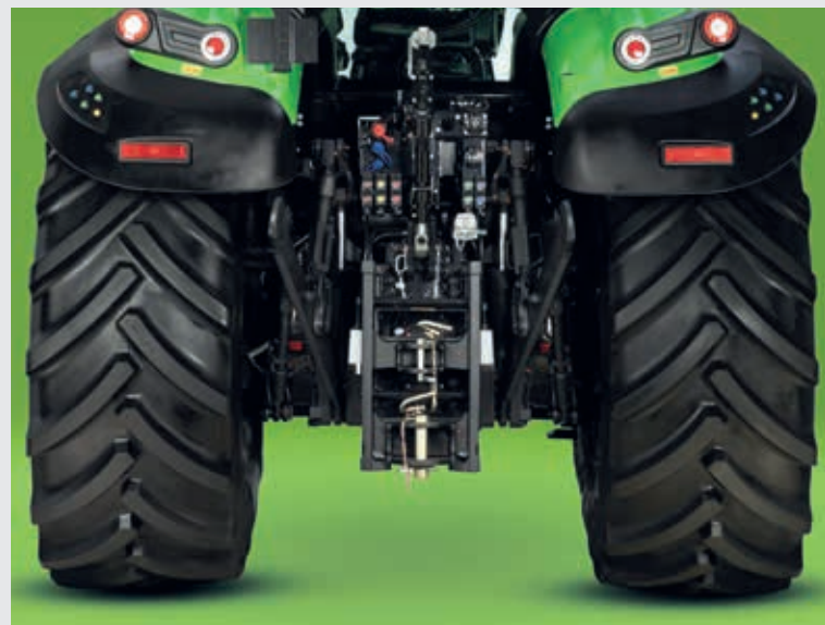
Heckkraftheber, fünf Heck-Zusatzsteuerventile, externe Bedienelemente an den Kotflügeln auf beiden Seiten.
