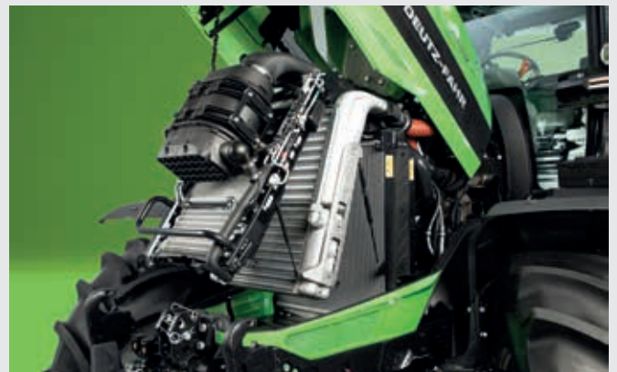
↑ Aluminium-Kühlsystem mit Einhand-Zugangshebel und Powercore-Luftfilter.
