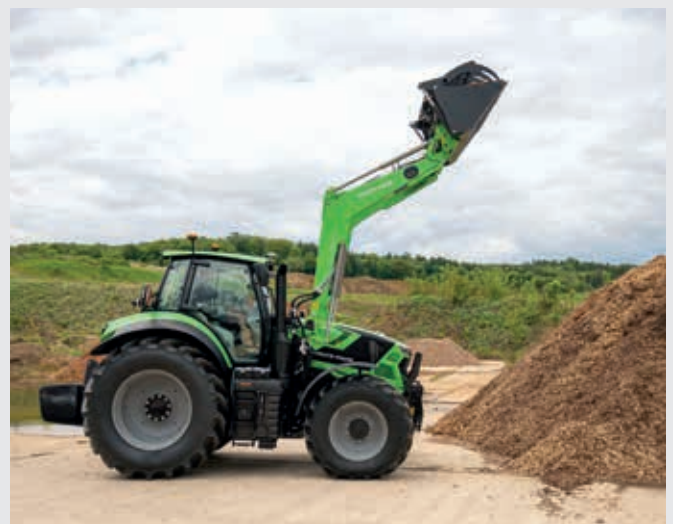
↑ Enorme Aushubhöhe von 4,5 m.
