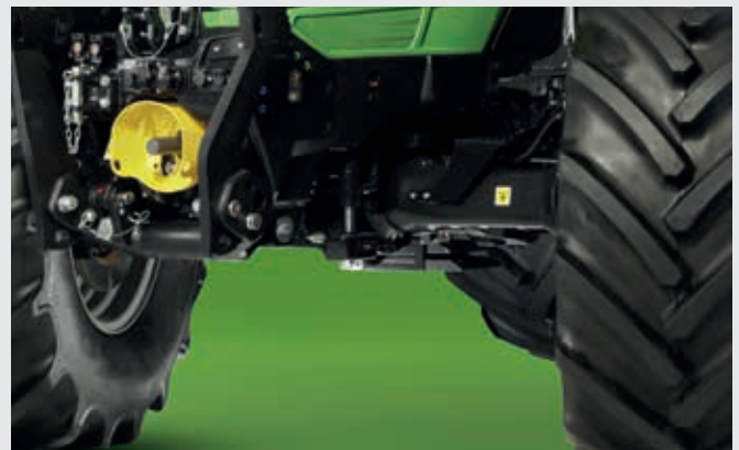
↑ Vorderradaufhängungskonzept mit hoher Bodenfreiheit und 3 Fahrhöhen, einstellbar im InfoCenter Pro .
