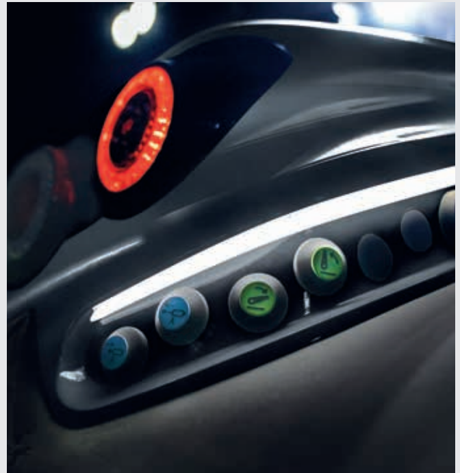
LED-Lichtleiste zur Beleuchtung der äußeren Bedienelemente.
