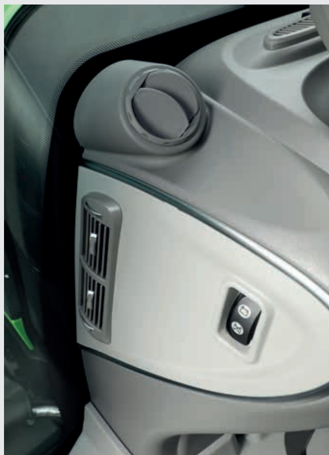
↑ Zusätzliche Luftdüsen und Batterie Hauptschalter komfortabel in der Kabine platziert.
