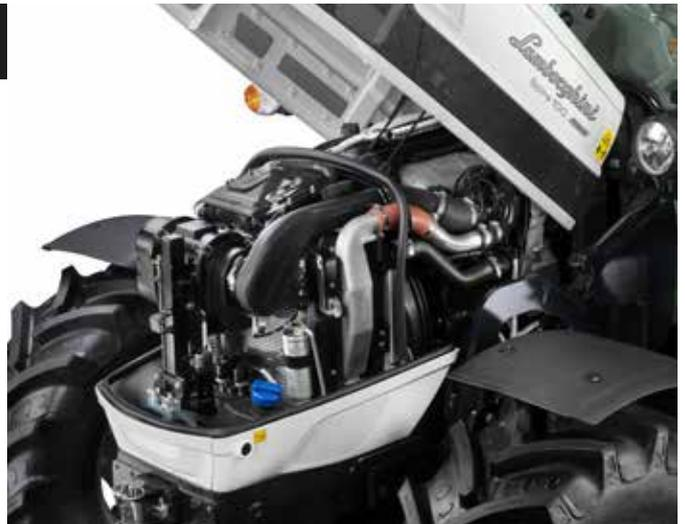
bereit. Die neue Struktur des Motorraums hat es außerdem ermöglicht, sowohl den DOC-Katalysator als auch den neuen 2-stufigen PowerCore-Luftfilter, der auf Wunsch mit einem Staubabscheider ausgerüstet werden kann, geschützt unter der Motorhaube unterzubringen. Um die regelmäßige Wartung zu vereinfachen, wurden zwei herausnehmbare Schmutzgitter in das Kühlpaket integriert und alle Servicestellen für die regelmäßigen Kontrollen noch leichter zugänglich gemacht.
