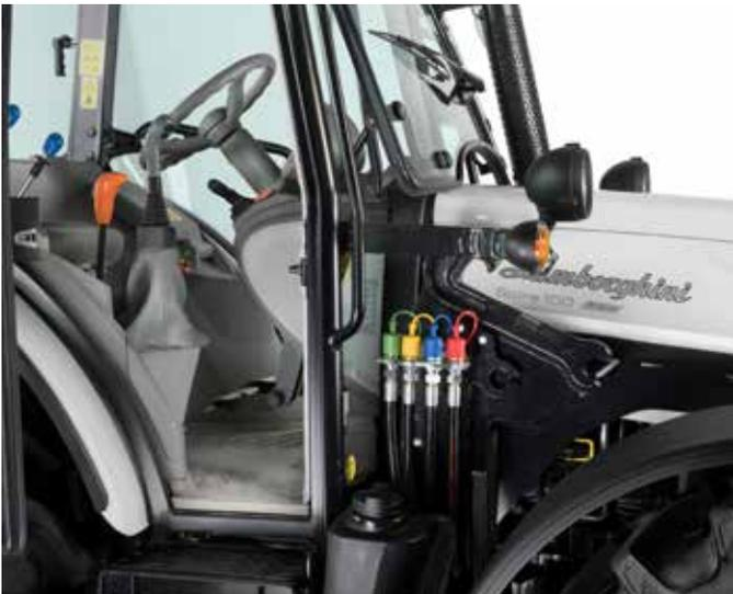
Der Spire Trend kann auch für den Einsatz mit Frontladern ab Werk vorgerüstet werden; Light- oder Ready-Kits sind direkt und vollständig integriert erhältlich. Das Light-Kit umfasst dabei die Anbaukonsolen, wohingegen das Ready-Kit sowohl alle Hydraulikkomponenten, die Elektronik und die Bedienelemente beinhaltet.
