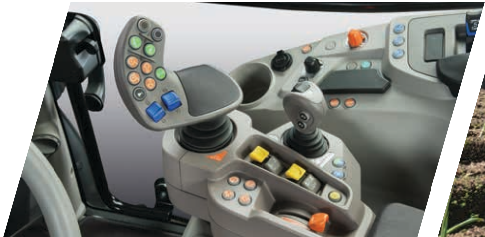
> Ergonomische Armlehne mit MaxCom-Joystick
