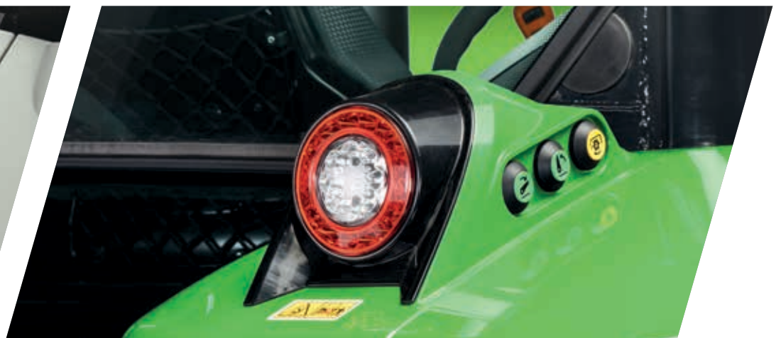
> Externe Bedienelemente für Zapfwelle und Heckkraftheber.
