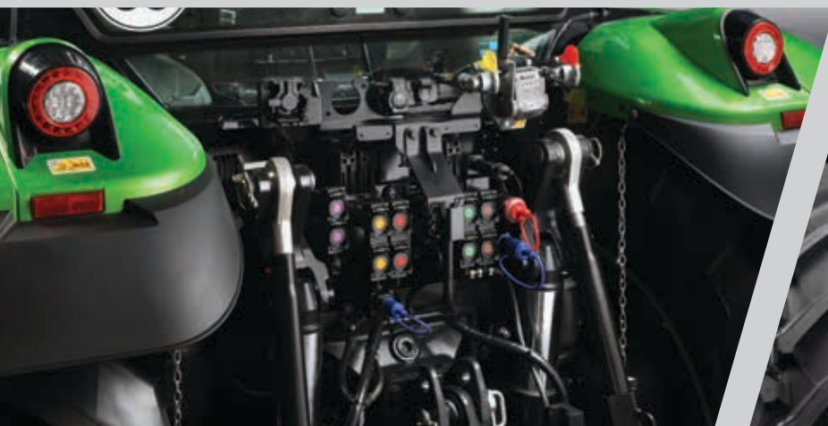
> Bis zu 10 Anschlüsse hinten zusätzlich zu den Power Beyond-Anschlüssen.
